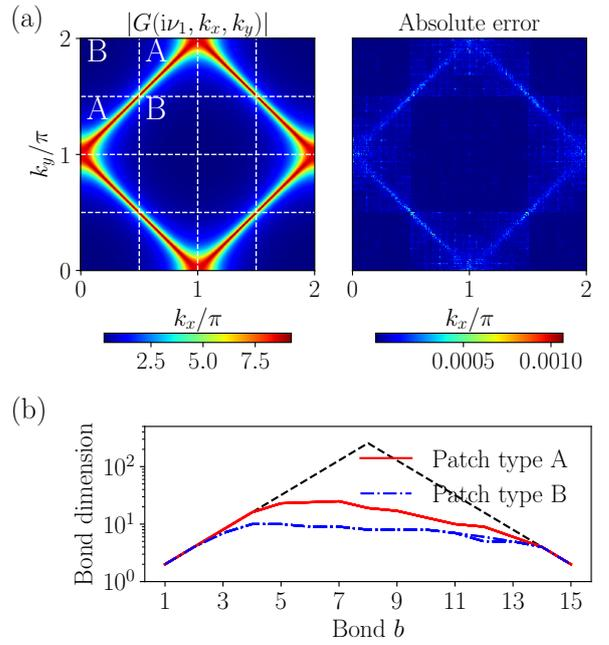
図 4 揺らぎ交換近似による 2 次元正方格子 Hubbard 模型のグリーン関数 ( $T = 0.03, U = 1.1$ ). (a) 左図にオリジナルデータ, 右図に圧縮前後での誤差が示されている. 有効な桁数は 4 桁程度である. 波数空間の構造が圧縮に与える影響を観察するため, 波数空間を 16 個に分割するパッチを採用した. (b) ボンド次元のボンド依存性. パッチ A とパッチ B のそれぞれについて示されている. 黒点線は, まったく圧縮できない場合を示す. パッチ A と B について, 圧縮前後のデータサイズ比 (圧縮率) はそれぞれ 10.86 と 45.20 である.
