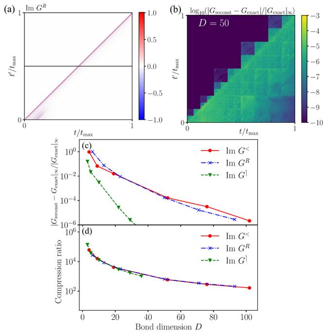
図5 非平衡動的平均場理論により求められた Hubbard 模型の非平衡グリーン関数. (a,b)Retarded グリーン関数  $G^R(t, t')$  の元データ (a) と QTT 圧縮されたデータと元データの違い (b). (c,d) Retarded, Lesser, Left-mixing 各成分の圧縮精度 (c) および圧縮率 (d) のボンド次元  $D$  依存性. ここでは元データに合わせ  $R = 12$  とした. これらのデータは、低温の反強磁性相が光励起で融解する場合のシミュレーションに対応する.
